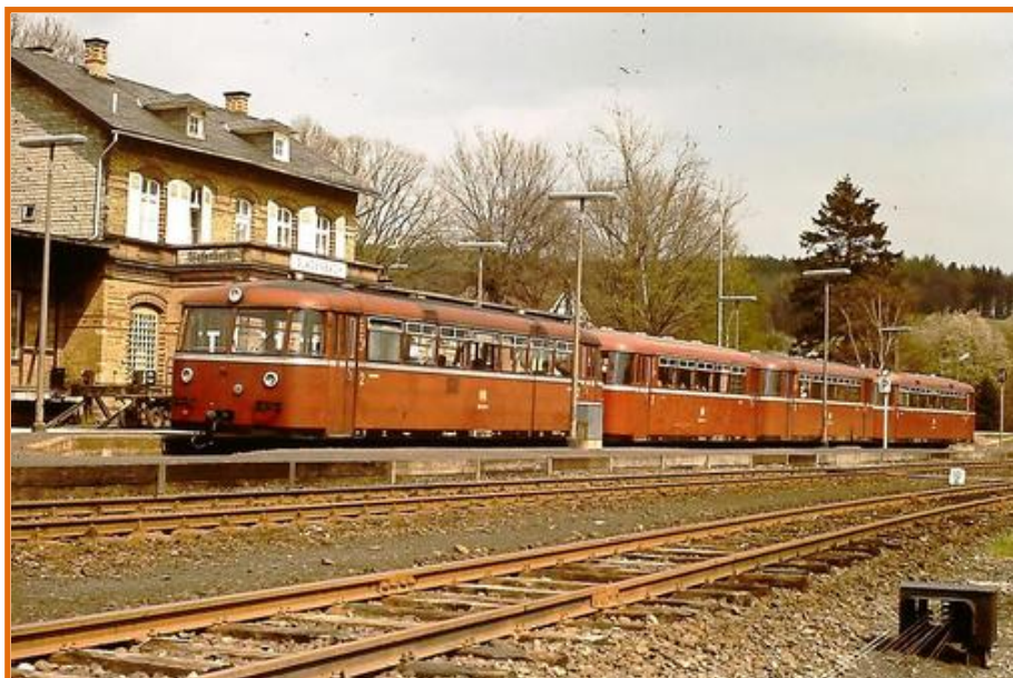
Der VT 95.9, hier bereits als BR 795, in den 1970ern im Bahnhof Gladenbach. Vorne und hinten die Triebwagen, in der Mitte die Beiwagen. In jedem Triebwagen sitzt ein Lokführer, die Verständigung erfolgt mittels Klingelleitung.
