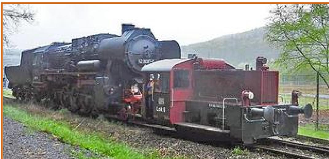
*Das Ziel ist fast erreicht: Die zur Sammlung gehörende Köf – Abkürzung für Kleinlok mit Ölmotor und Flüssigkeitsgetriebe – bringt die Dampflok von der Strecke in eine Halle. Solche Köfs waren auch auf den heimischen Bahnstrecken im Einsatz*
