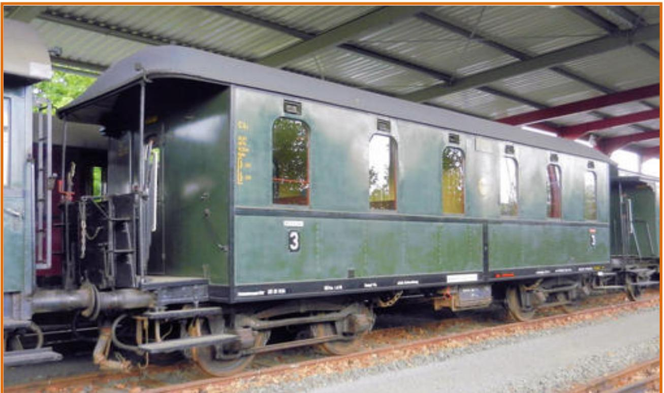
*Das Bild entstand beim Hessencourier und zeigt den ältesten erhaltenen Langenschwalbacher. Neben den Drehgestellen und dem Leichtbau waren die abgerundeten Dachenden ein weiteres Merkmal dieser Bauserie..*
